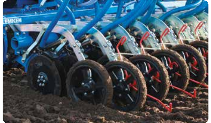
Mechanische Schardruckverstellung OptiDisc M mit bis zu 45 kg Schardruck
