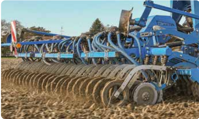
Hydraulische Schardruckverstellung OptiDisc H mit bis zu 70 kg Schardruck
