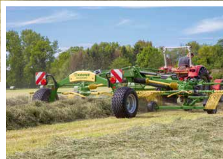
Swadro TC 680 dvourotorové středové shrnovače píce Záběr 6,80 m
