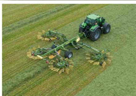
Swadro TC 1250 / 1250 Plus čtyřrotorové středové shrnovače píce Variabilní šířka záběru od 9,80 m do 12,50 m
