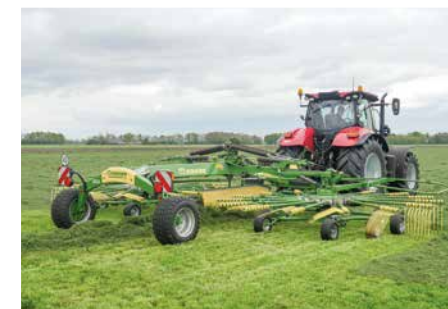
Swadro TC 1000 / 1000 Plus dvourotorové středové shrnovače píce Variabilní šířka záběru od 8,90 m do 10,00 m
