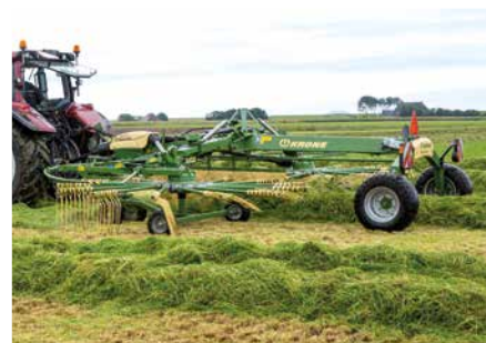
Swadro TC 880 / 880 Plus dvourotorové středové shrnovače píce Variabilní šířka záběru od 7,60 m do 8,80 m
