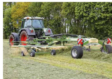
Swadro TC 930 / 930 Plus dvourotorové středové shrnovače píce Variabilní šířka záběru od 8,10 m do 9,30 m
