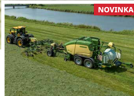
Swadro BaleTrain TC 880 Pro Dvourotorové středové shrnovače píce kombinované s lisem na válcové balíky – pro efektivní shrnování pokosů a lisování v jednom kroku
