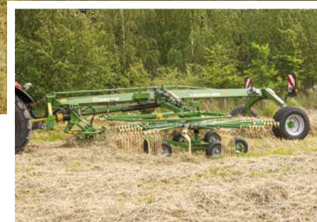
Swadro TC 760 / 760 Plus dvourotorové středové shrnovače píce Variabilní šířka záběru od 6,80 m do 7,60 m
