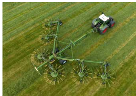
Swadro TC 2000 Pro Šestirotorový středový shrnovač píce Variabilní šířka záběru od 10,00 m do 19,00 m
