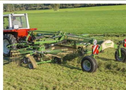
Swadro TC 640 dvourotorové středové shrnovače píce Variabilní šířka záběru od 5,70 m do 6,40 m
