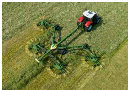
Swadro TC 1570 Pro Čtyřrotorové středové shrnovače píce Variabilní šířka záběru od 11,00 m do 15,70 m
