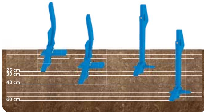
Das Lockerungsschar (OL) und sein Halsenschutz – optional mit einem 25 cm breiten Flügel – sind an einem geraden Halm montiert und für die tiefe Lockerung gedacht. Es wird vorzugsweise in Arbeitstiefen zwischen 40 und 60 cm eingesetzt, um **Bodenverdichtungen aufzubrechen, ohne viel Erde zu bewegen**.
