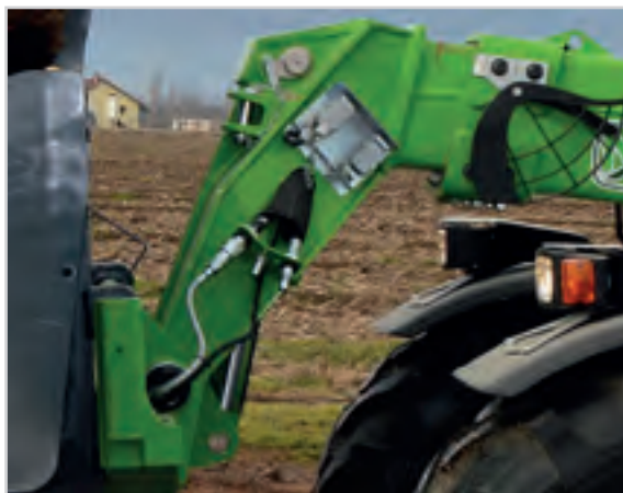
trubky, elektrické kabely a hydraulická vedení umístěné uvnitř ramene – maximální ochrana
