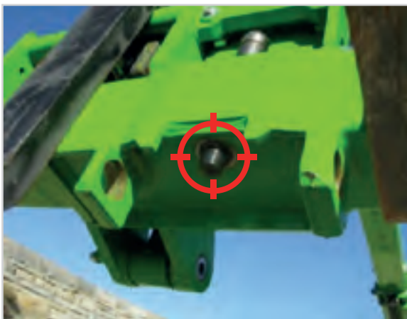
Tac-Lock: systém hydraulického připojení adaptéru ovládaný z kabiny
