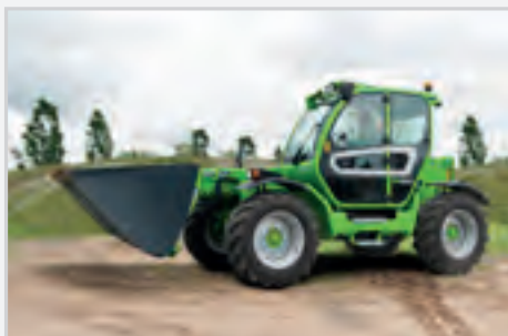
Hydropneumatické odpružení ramene BSS (volitelná výbava) ovládané obsluhou. Automatická deaktivace při rychlosti nižší než 3 km/hod pro maximální přesnost při umístění nákladu.
