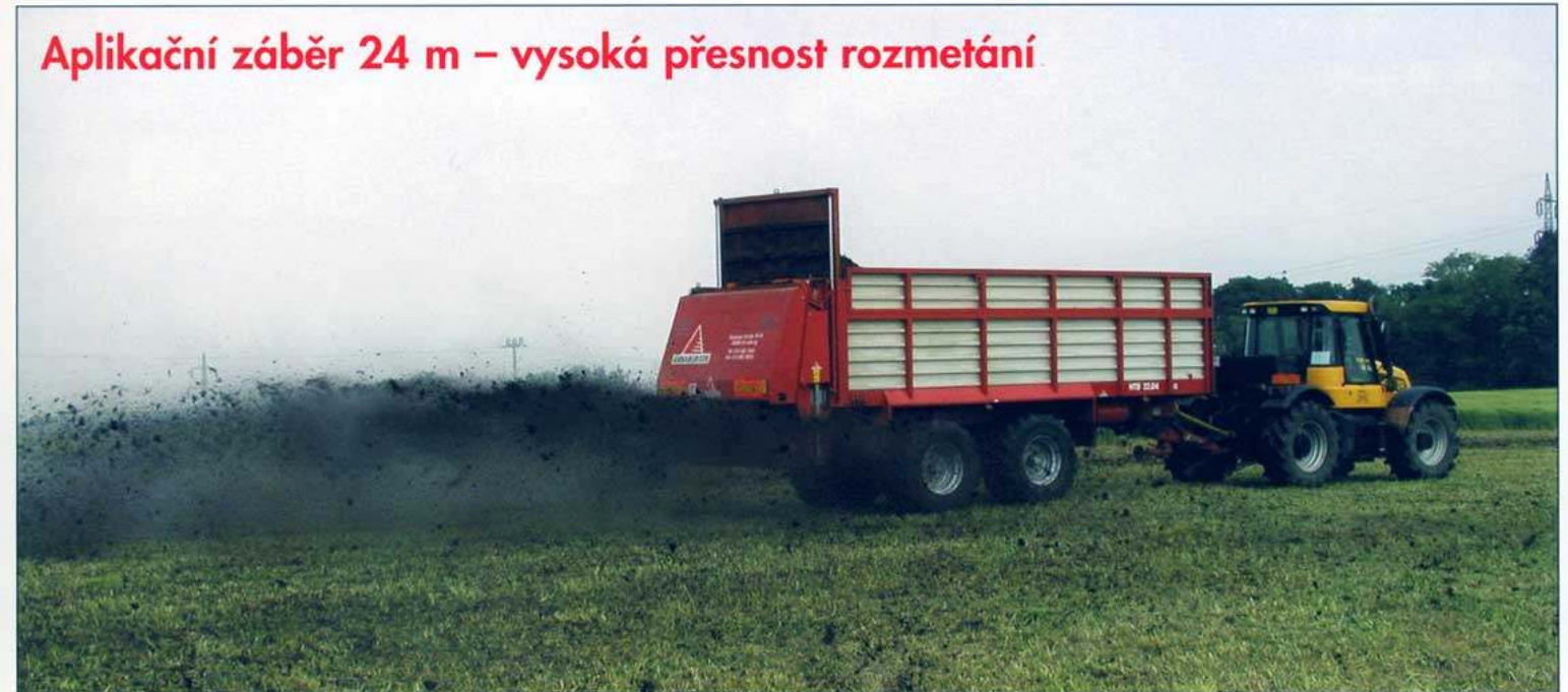
Rozmetadlo kompostů HTS 22.04 o objemu 26 m 3 se vzduchem odpruženým podvozkem
