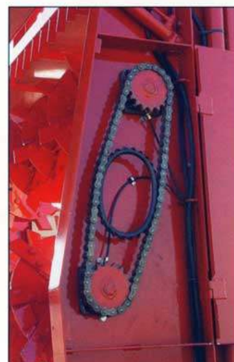
Detail pohonu prvního frézovacího válce s napínáním řetězu (obr. vlevo). Obrázek vpravo zobrazuje pohon druhého frézovacího válce
