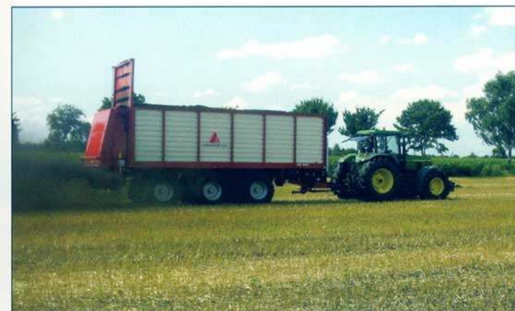
Rozmetadlo kompostů HTS 32.04 o objemu korby 34 m 3
