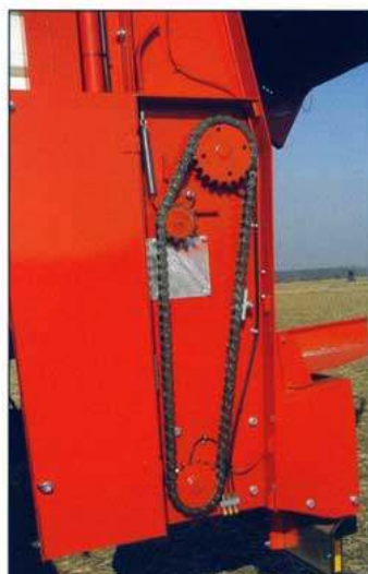
Detail pohonu prvního frézovacího válce s napínáním řetězu (obr. vlevo). Obrázek vpravo zobrazuje pohon druhého frézovacího válce
