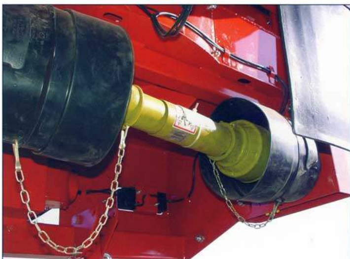
Detail vačkové spojky jistění frézovacích válců
