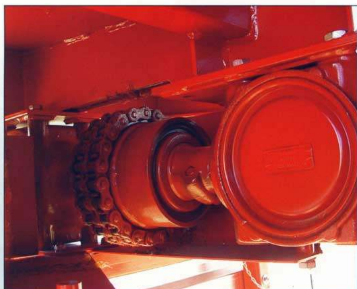
Vačková spojka a 2 řetězové spojky s volnoběžnou spojkou chrání rozmetací talíře před přetížením
