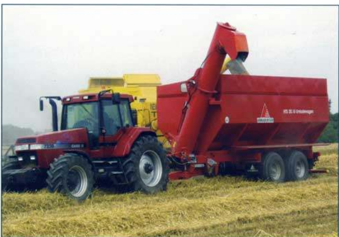
Překládací vůz HTS 20.16 s kloubovými výkyvnými nápravami
