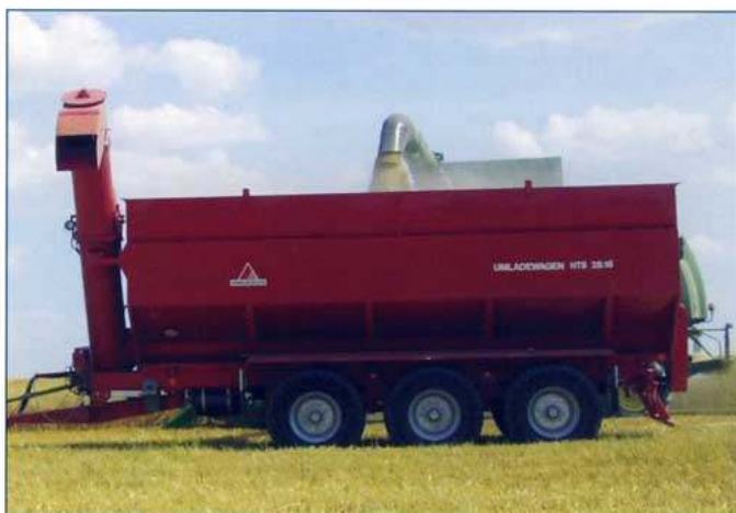
Překládací vůz HTS 29.16 s parabelickým odpružením náprav
