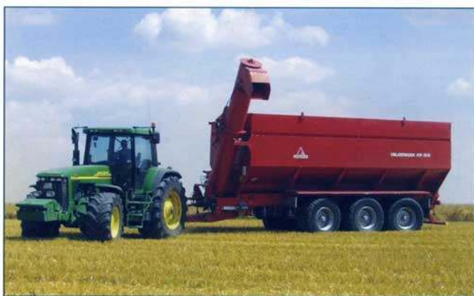
Překládací vůz HTS 29.16 o objemu 33 m 3
