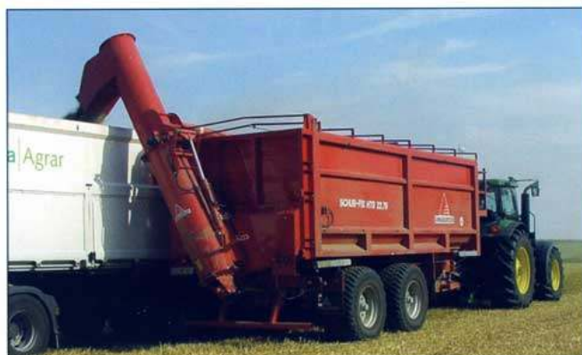
Vyprazdňování obilí výtlačným čelem a šnekem. Vůz vyprázdní 29 m 3 za 3 minuty
