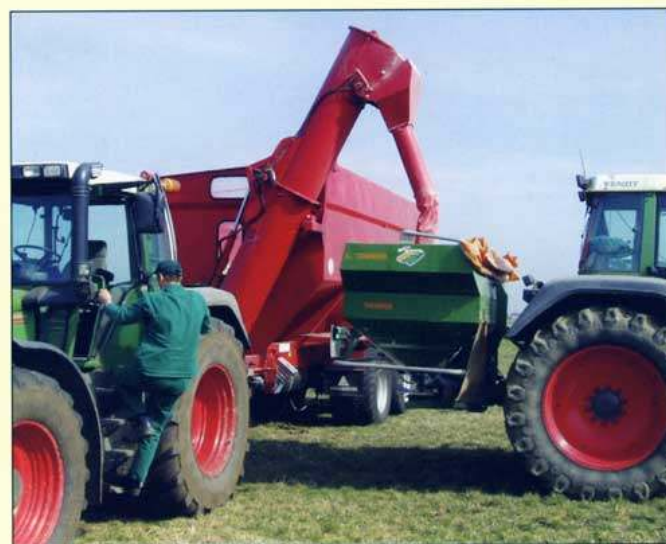
Plnění neseného rozmetadla minerálních hnojiv. Pohon ležícího šneku je proveden hydraulicky
