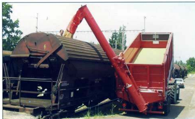
Se zadním plnicím šnekem lze plnit i železniční vagóny bez rampy.
