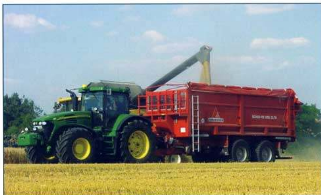
Výměnný systém MP HTS 22.79 s nástavbou Schubfix o objemu 29 m 3
