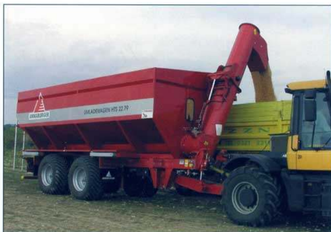
Překládací vůz HTS 22.16 s hydraulickým odpružením náprav
