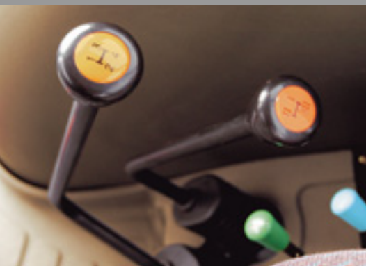
Snadná a rychlá změna směru jízdy pomocí páky reverzace na levé straně.
