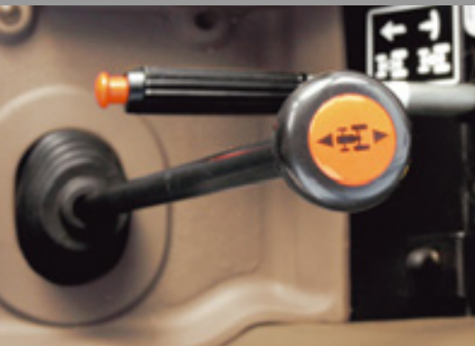
Snadná a rychlá změna směru jízdy pomocí páky reverzace na levé straně.
