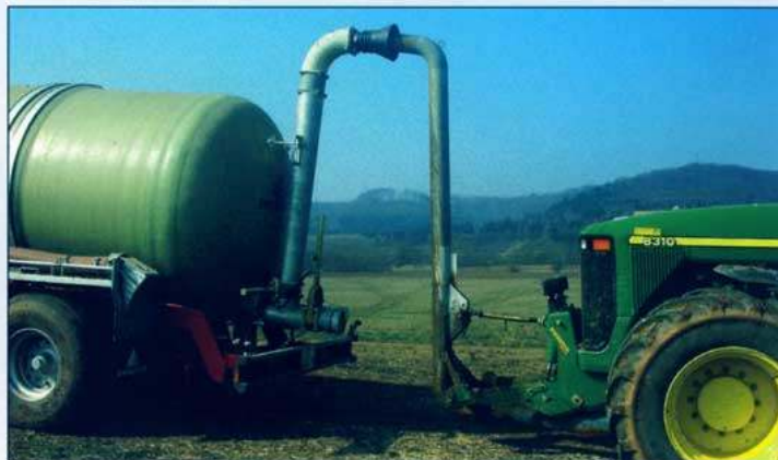
Čelní spojovací systém s přívoznou cisternou Annaburger
