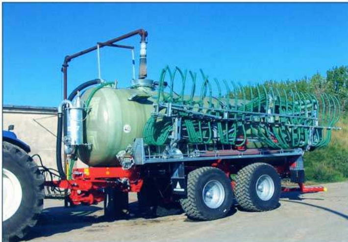
Systém horního plnění cizím čerpadlem u cisterny HTS 22.27 – 18 m 3
