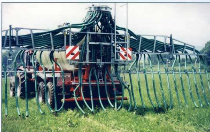
MultiLand Plus HTS 29.79 o objemu 21 m 3 jako přívozná cisterna
