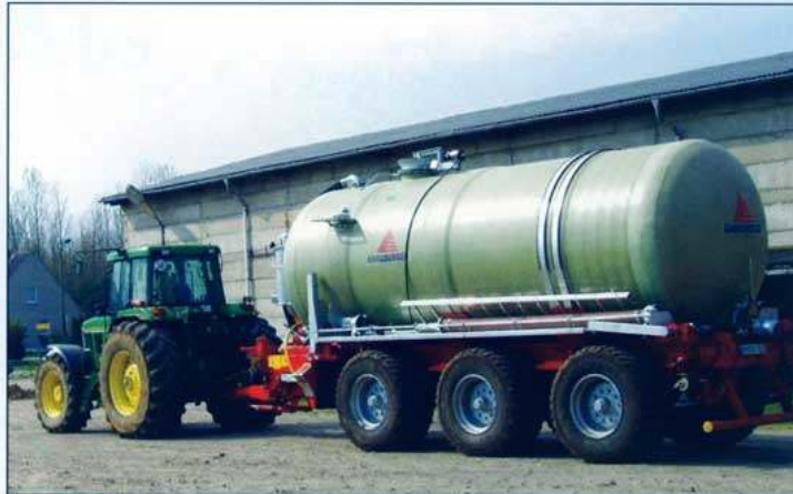
MultiLand Plus HTS 29.79 o objemu 21 m 3 jako přívozná cisterna
