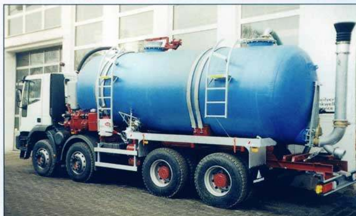
Přívozná cisterna Annaburger o objemu 20 m 3 na nákladním automobilu Iveco
