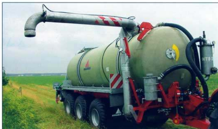
Stranová nasávací ruka u cisterny HTS 29.27 o objemu 21 m 3
