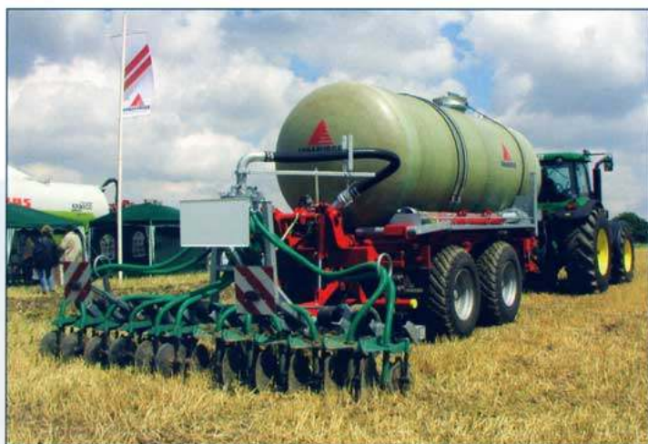
Diskový aplikátor Annadrill o záběru 4,5 m
