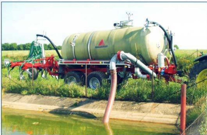
Nasávací ruka o průměru 200 mm u cisterny HTS 20.27 – 15 m 3
