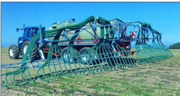
Hadicový aplikátor Ex 30+30 se záběrem 18 m
