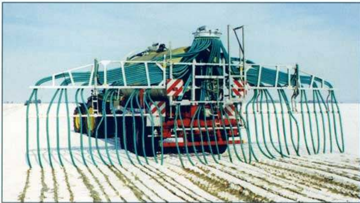
Hadicový aplikátor s jednou hlavou a záběrem 9 m
