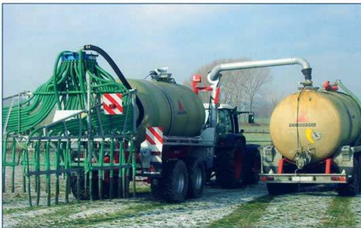
Stranová nasávací ruka mezi aplikační a přívoznou cisternou
