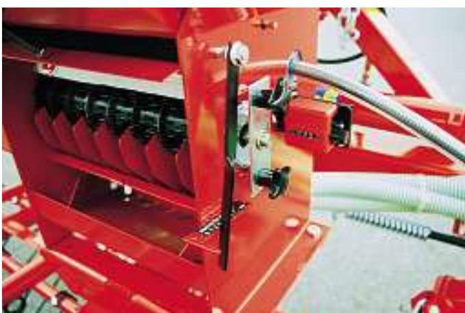
Pákou se nastaví rozteč stěrky podle velikosti osiva. Hektaroměr je vybavení na přání.
