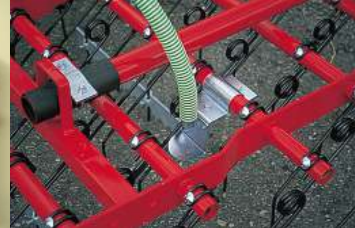
Přesné rozdělení osiva se dosáhne speciálně tvarovanými plechy
