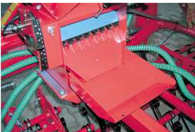
Jednoduché dávkování pákou. Vanička pro zkoušku výsevku tvoří dno.
