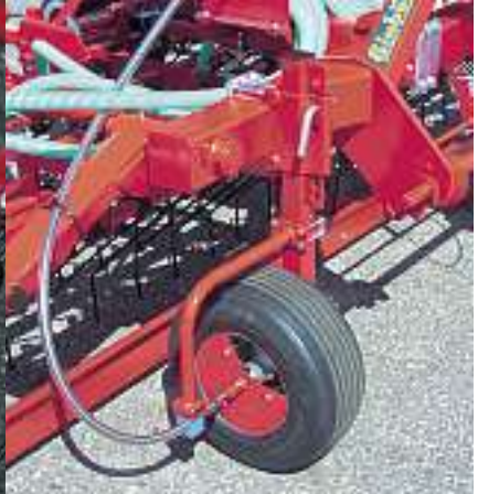
Přesné dávkování pohonem od kola. Přenos síly ke stroji bovdenovou hnci hřídlel. Rychlozávěsná tyč a pohon od kola jsou u všech strojů dodávány sériově.
