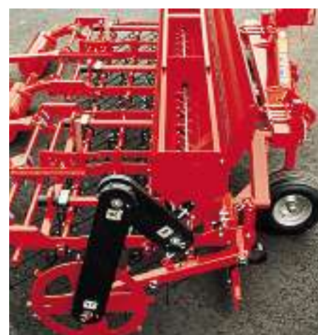
Pohon výsevního ústrojí (čechrače) od ostruhového kola
