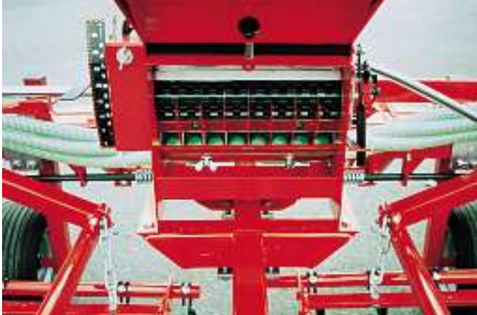
Jeden vlastní výsevní váleček na jednu hadici, který je sériově dodáván, umožňuje stejný výsev ve svazitých terénech.
